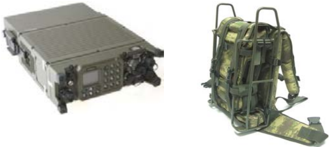
Рисунок 1.6 – Зовнішній вигляд переносного варіанту радіостанції VRC 9661 (Manpack 10 Вт).
