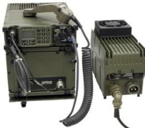
Рисунок 1.9 – Зовнішній вигляд стаціонарного варіанту радіостанції VRC 9661 (50 Вт).
