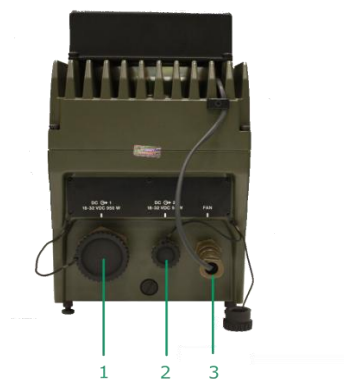
Рисунок 1.17 - Зовнішній вигляд задньої панелі блоку живлення базової станції.
