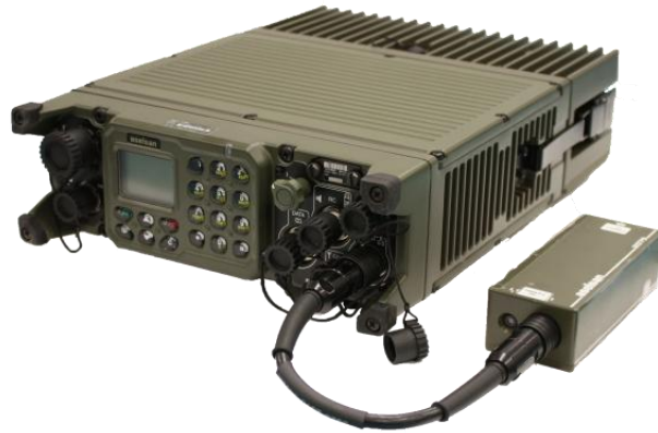
Рисунок 4.3 – Підключення пристрою FILLGUN2070 А до радіостанції.
