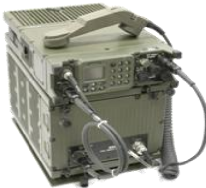
Рисунок 1.8 – Зовнішній вигляд автомобільного варіанту радіостанції VRC 9661 варіант (50 Вт).
